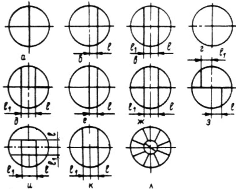
Рис. 2. Расположение сварных швов заготовок выпуклых днищ
