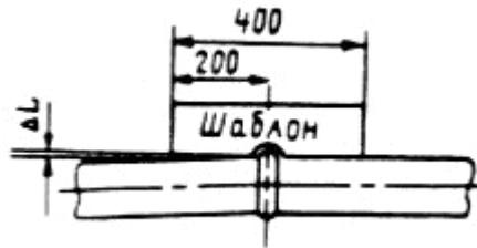
Рис. 12. Схема определения отклонения от прямолинейности оси трубы
