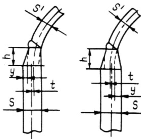
Рис. 3. Узел соединения дна с обечайкой
