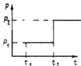
где  $P_1$  - давление пуска,  $P_2$  - рабочее давление,  $t_1$  - наименьшая температура воздуха, при которой допускается пуск сосуда под давлением  $P_1$ ,  $t_2$  - минимальная температура, при которой сталь и ее сварные соединения допускаются для работы под давлением в соответствии с требованиями обязательных приложений 2-6 и 11-14 настоящего стандарта.
