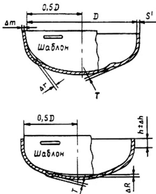
Рис. 7. Отклонения размеров и формы эллиптического днища
