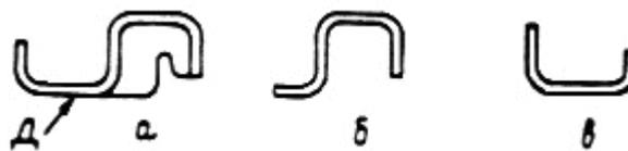
Рис. 22. а - S-образный элемент; б - колпачок; в - желоб
