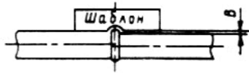
Рис. 11. Схема определения смещения кромок стыкуемых труб
