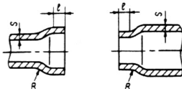
Рис. 6. Отбортованный и переходный элементы
