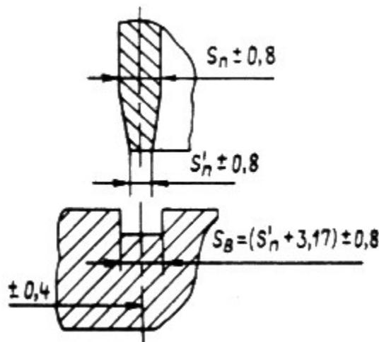
Рис. 30. Узел соединения перегородки с решеткой
