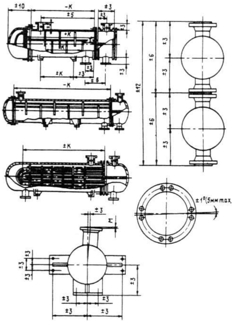
Рис. 27. Предельные отклонения габаритных и присоединительных размеров
