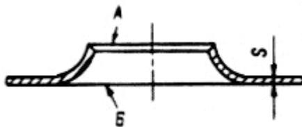
Рис. 23. Часть полотна тарелки в месте крепления патрубка
